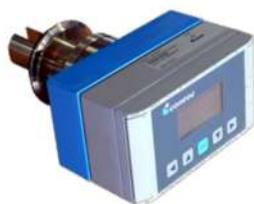
Determinação altamente precisa de concentração do meio tal como açúcar, álcool, ácido ou cáustico Baseado na medição da velocidade do som dentro de um líquido Ideal para monitorar a qualidade da matéria prima e do produto final. Medição em diversas unidades inclusive BRIX para indústria de suco de frutas.
